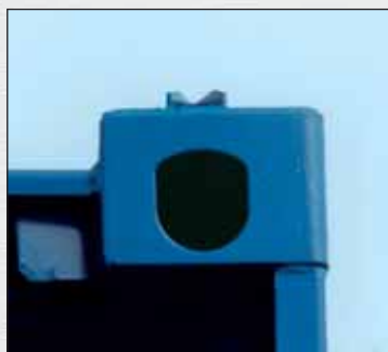
Otvori za kran
